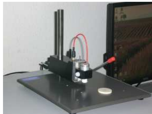
Figure 2 : Cellule de mesure 4 pointes à l'ambiante (Jandel)
