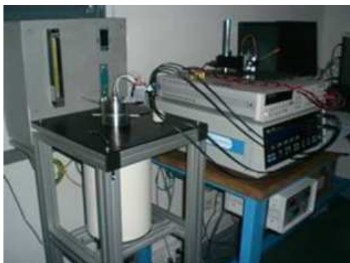
Figure 3 : Banc de test de conductivité ionique
