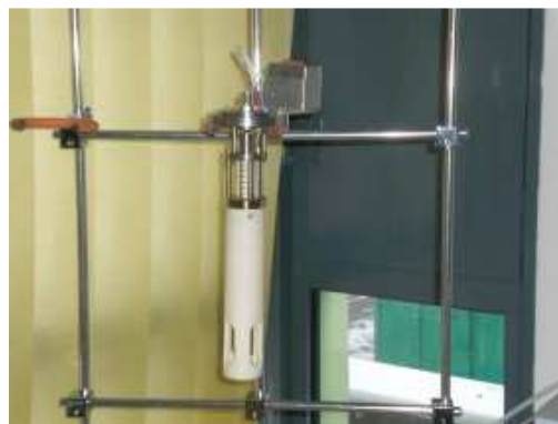
Figure 4 : Cellule de mesure 2 pointes de conductivité ionique
