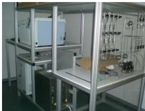
Figure 5 : Banc de catalyse équipé d'un chromatographe en phase gazeuse
