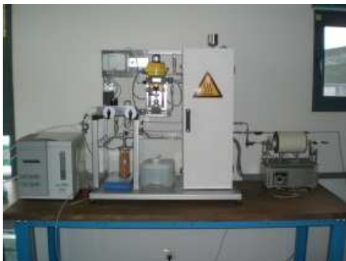
Figure 1 : Platine de gaz des bancs de test
